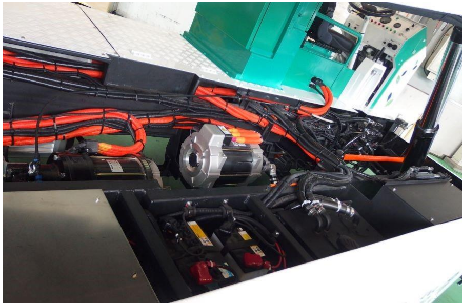
左手前:走行用モーター(半分隠れている)、中央:油圧ポンプ用モーター
